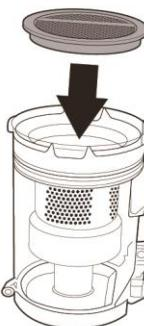
8. Nasadte zpět prachový uzávěr na hlavní tělo tak, že zaháknete kanál na horní straně prachového uzávěru výstupkem na hlavním tělese (1). Zatlačte nádobku na prach zpět k hlavnímu tělu, dokud neuslyšíte zacvaknutí na místo (2).
