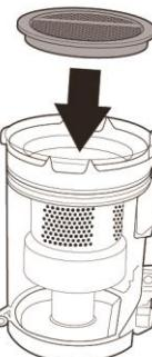
8. Umieścić pojemnik na kurz na korpusie głównym, zaczepiając kanał na górze pojemnika na kurz z końcówką na korpusie głównym (1). Wepchnąć pojemnik na kurz z powrotem do korpusu, aż do kliknięcia (2).
